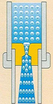
エコバルブ設置前・設置後の流量の比較
